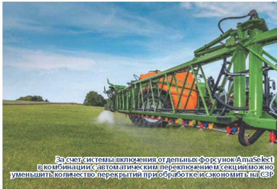
рехсекционного держателя форсунок с электронным переключением и отключением. Так, система предлагает, наряду с секцией 50 см, которая может автоматически включаться через GPS-Switch, электронное переключение форсунок через терминал управления.
