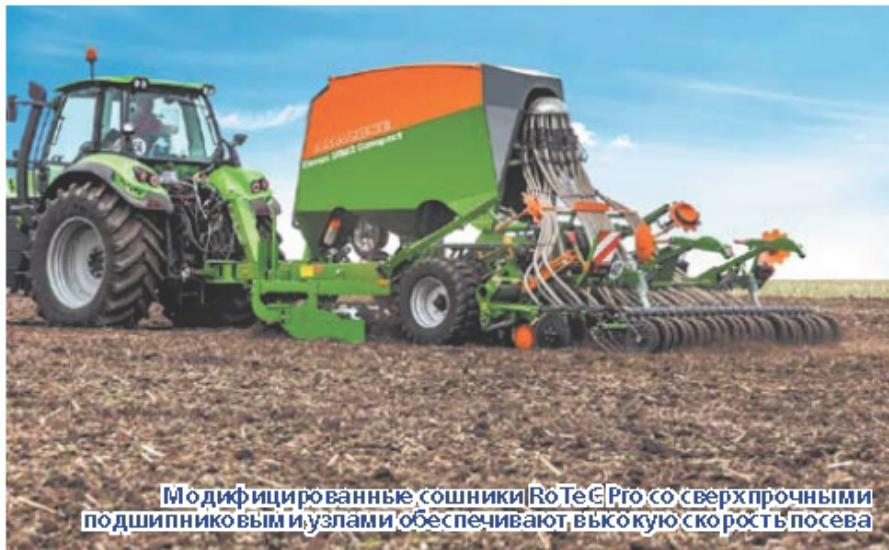
Модифицированные сошники RoTeC Pro со сверхпрочными подшипниками обеспечивают высокую скорость посева
