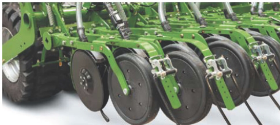
Система двухдисковых сошников TwinTeC+ предлагает бесступенчатую гидравлическую настройку давления на сошник в пределах от 15 до 100 кг
